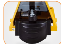
Захисна кришка Захист приводного двигуна, Анти-топкання
