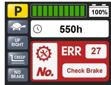
Wenn eine Fehlfunktion auftritt und bestätigt ist, dass es sich nicht um einen Verdrahtungsfehler oder einen mechanischen Fehler im Fahrzeug handelt, kann versucht werden, das Fahrzeug über den Fahrzeugschlüsselschalter neu zu starten. Wenn der Fehler weiterhin besteht, schalten Sie den Schlüsselschalter aus, prüfen Sie, ob der Stecker richtig angeschlossen oder verschmutzt ist, reparieren und reinigen Sie ihn, schließen Sie ihn erneut an und versuchen Sie es dann erneut.
