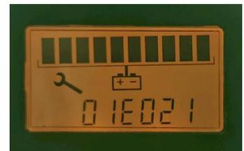
Wenn eine Fehlfunktion auftritt und bestätigt ist, dass es sich nicht um einen Verdrahtungsfehler oder einen mechanischen Fehler im Fahrzeug handelt, kann versucht werden, das Fahrzeug über den Fahrzeugschlüsselschalter neu zu starten. Wenn der Fehler weiterhin besteht, schalten Sie den Schlüsselschalter aus, prüfen Sie, ob der Stecker richtig angeschlossen oder verschmutzt ist, reparieren und reinigen Sie ihn, schließen Sie ihn erneut an und versuchen Sie es dann erneut.
